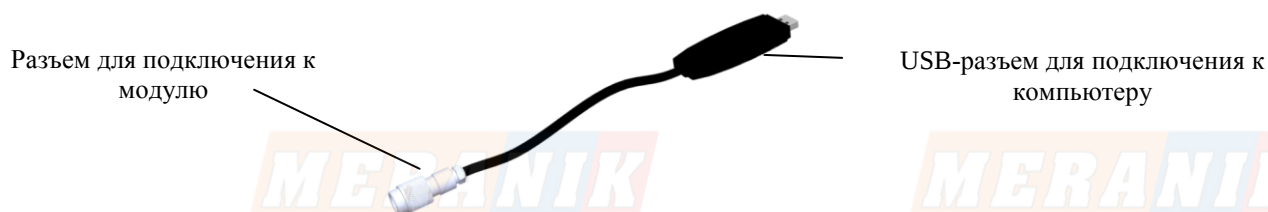
Рисунок 8 – Весовой адаптер USB/МК,ТВ
