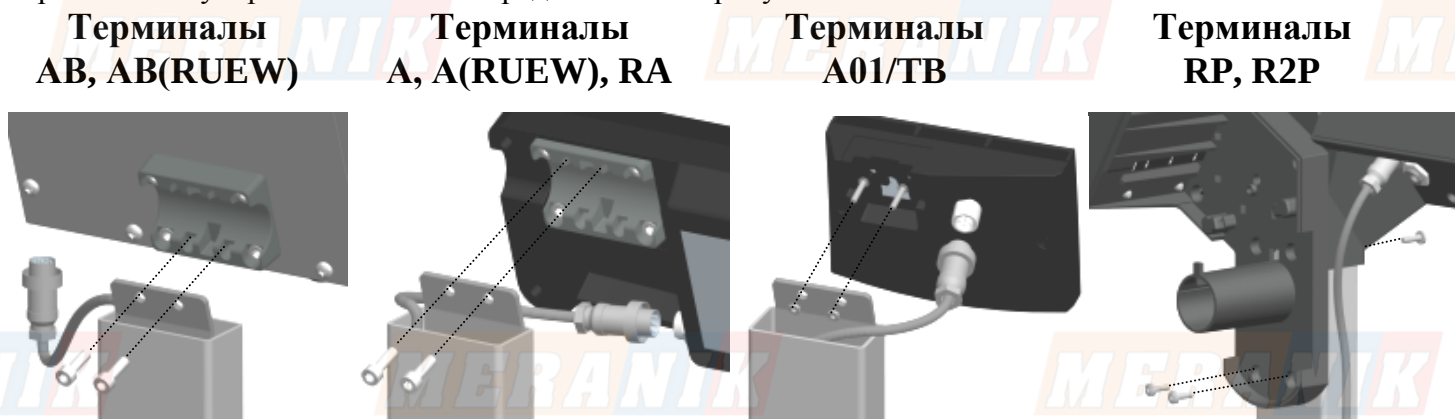
Рисунок 7 – Установка терминалов на укороченной стойке
